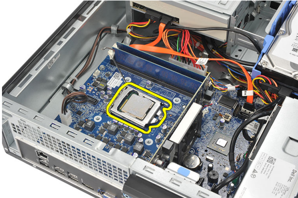
8. הרם את המעבד כדי להסירו מהשקע ולאחר מכן הנה אותו באריזת הגנה מפני חשמל סטטי.
